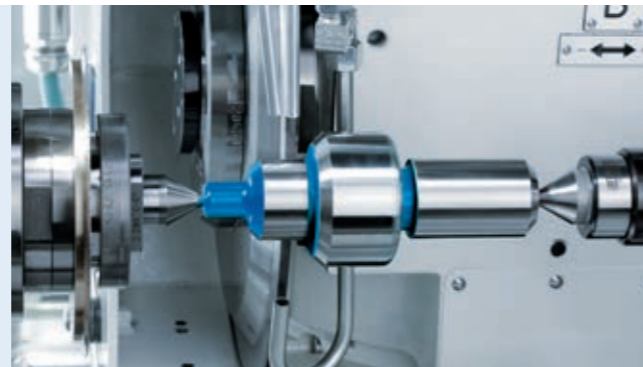
Werkstückmitnahme zwischen Spitzen, d.h. ohne Spannfutter
